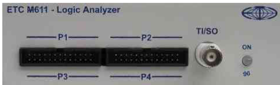
Obrázok 3.1.1. – Čelný panel prístroja
