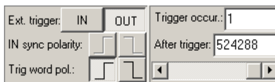
Obrázok 4.3.1.1. – Časť panelu spúšťacieho systému ovládajúca spúšťanie
